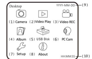
**(1) Kamera oder Normaler Modus:** Wählen Sie diesen Modus für das Vergrößern von Objekten am Display und zur Aufnahme von Bildern.
